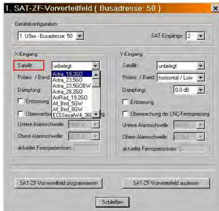
Bild 4: SAT-ZF-Vorverteilerfeld, Eingänge belegen
